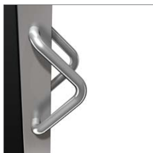
Trekantsformat draghandtag med dolda infästningar. Höjd 300 mm, Ø 30 mm. Aluminium.
